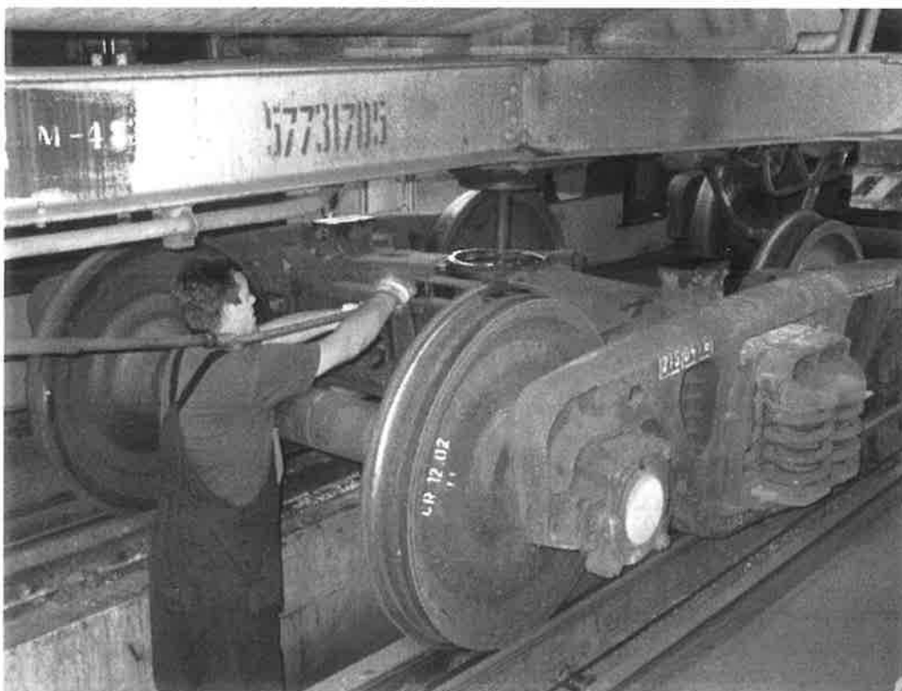
Ci-dessus et ci-dessous : Déconnexion des bogies dans l'atelier
